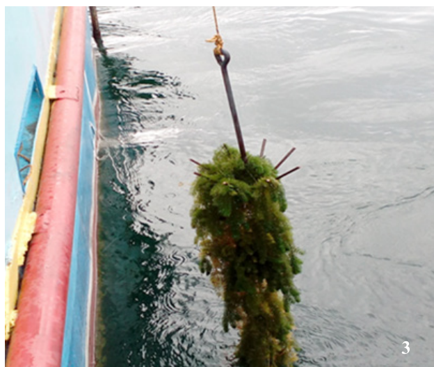
Фото 3-4. Исследование зарослей макрофитов в озере Севан с помощью зарослечерпателя (3) и дночерпателя Петерсена (4)
